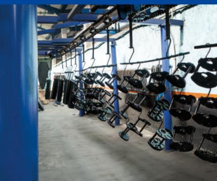
PARS treyler park ayaklarında kullanılan tüm parçalar elektrostatik toz boyası ile boyanmaktadır. Elektrostatik toz boyası zorlu performans şartlarının olduğu, yüksek film kalınlıkları gerektiren durumlar için en uygun boyama metodlarından biridir. Elektrostatik toz boyası sayesinde ürünlerimiz yüzeylerinde kusursuz boyama tabakası oluşturulmakta, böylelikle ürünlerde uzun ömürlülük, temizleme kolaylığı ile birlikte estetik bir görünüm sağlanmaktadır.
